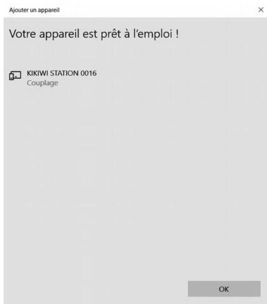
Et voilà le Bluetooth de la station appairée avec le Bluetooth de l'ordinateur à travers un port COM virtuel (Virtual Com Port ou VCP)
