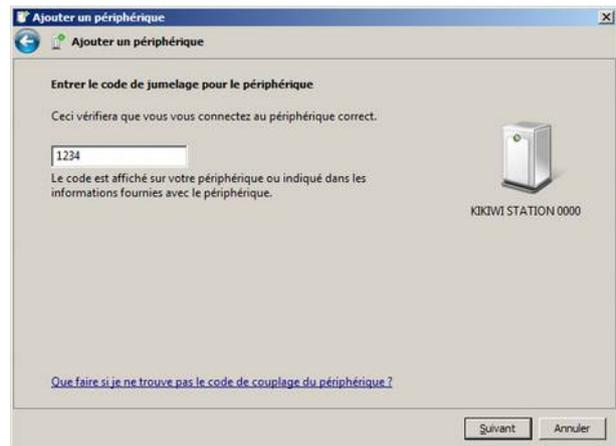
Et voilà le Bluetooth de la station appairée avec le Bluetooth de l'ordinateur à travers un port COM virtuel (Virtual Com Port ou VCP)
