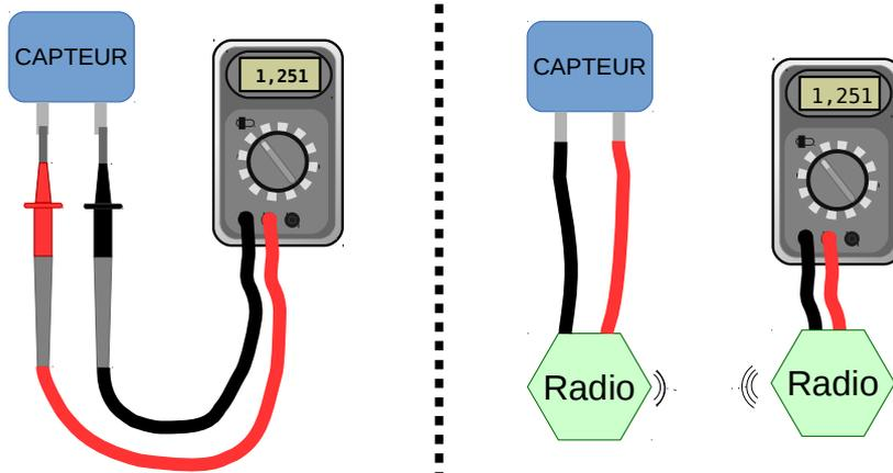
Dans le système Kikiwi, les pointes de touche du schéma de gauche sont remplacées par une liaison radio.
