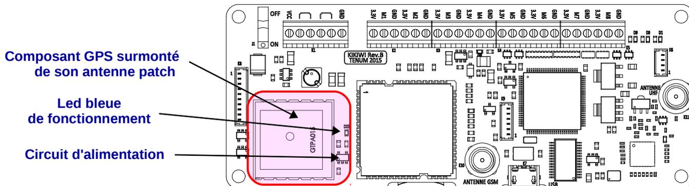
L'antenne patch de réception radio des informations des satellites GPS est solidaire du composant GPS. Sa position optimale est l'horizontale, mais elle fonctionne également très bien en position verticale. Par contre, il est recommandé de ne pas la placer face contre sol.
