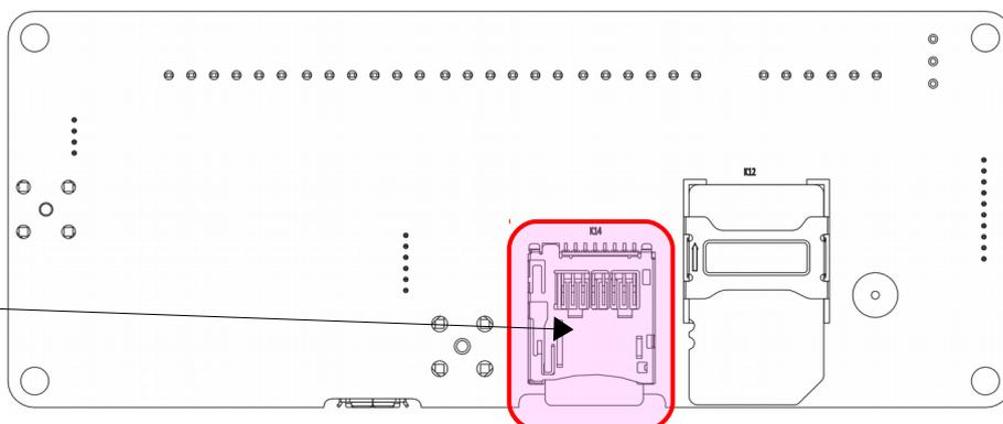
La carte doit être en place avant la mise sous tension de la carte Kikiwi
