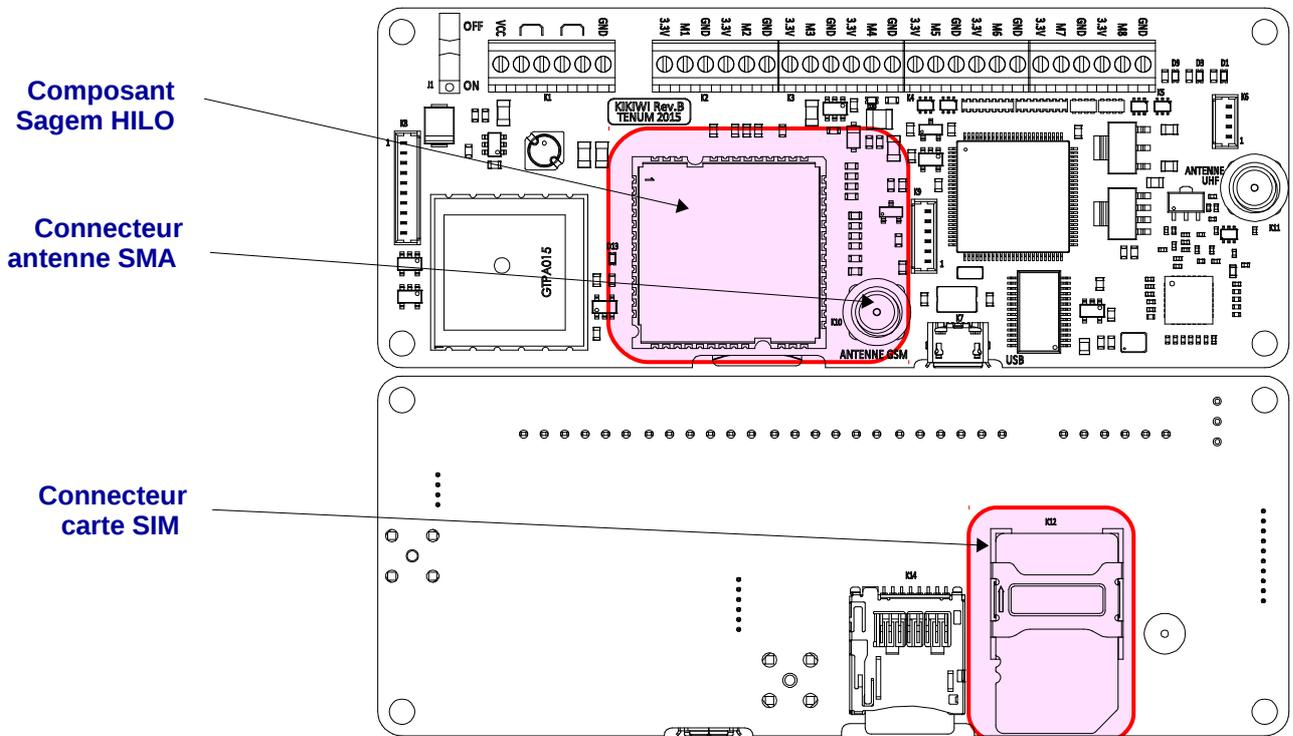
La carte SIM doit être placée de manière à respecter le profil dessiné en blanc sur le circuit imprimé.
