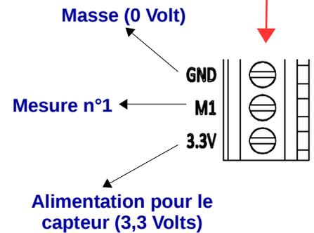
Pour brancher les fils électriques, utiliser un tournevis plat 2x75 :
