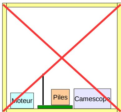
Le fonctionnement des appareils électroniques secondaires peut nuire à la réception GPS et à l'émission radio du Kikiwi.
