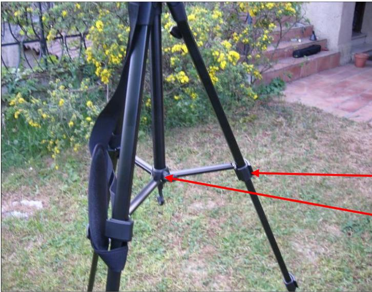
Attache de verrouillage d'un tronçon de pied
