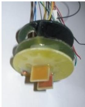
Exemple de montage des électrodes, avec une thermistance (à gauche) sous un fluorimètre. Le tout sera monté dans un tube suivant le schéma ci-dessus.
