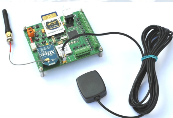
Carte d'acquisition équipée de l'antenne GPS et de l'antenne X-Bee
