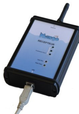
Récepteur équipée d'une antenne X-Bee et d'une liaison USB
