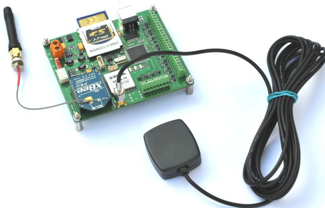
Carte d'acquisition équipée de l'antenne GPS et de l'antenne X-Bee.
