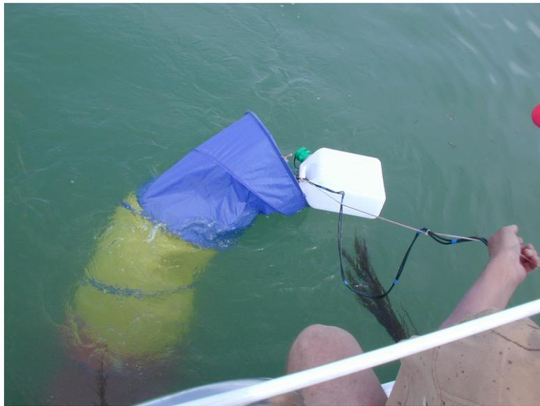
Mise à l'eau une ancre flottante réalisée avec un tunnel de tissu. Cette version ne comprenait pas de trous pour améliorer la circulation de l'eau à travers l'ancre et la rendre plus efficace.
