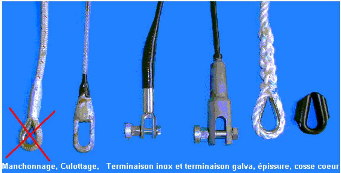
**Le manchonnage** : Il est à proscrire surtout sur les câbles présentant une élasticité ou pour les mouillages de plusieurs semaines. Dans le premier cas le câble en s'allongeant diminue de diamètre et il glisse dans le manchon. Dans le second cas le métal du manchon est attaqué par corrosion ou électrolyse d'où rupture à plus ou moins long terme.
