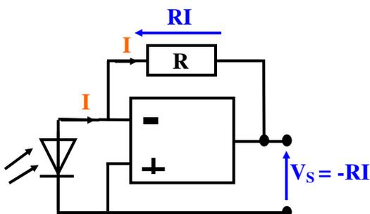
La mesure  $V_s$  associé à la connaissance de la valeur de  $R$  permet de déterminer la valeur de  $I$ . Une courbe donnant la relation entre l'éclairement et la valeur de  $I$  en court-circuit permet de déterminer l'éclairement reçu par la photodiode. Ce type de courbe est fourni par le constructeur dans la fiche technique (datasheet) de la photodiode.
