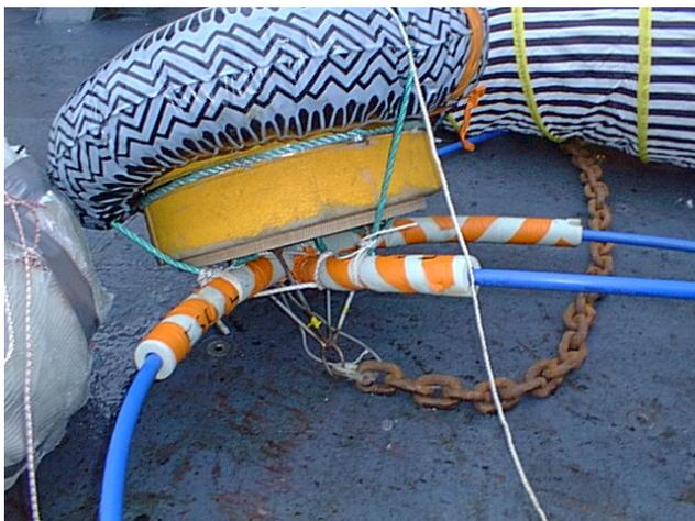
Exemple de chaîne d'acier utilisée comme lest d'une bouée. Ici la bouée Araignée réalisée par une école du Languedoc-Roussillon
