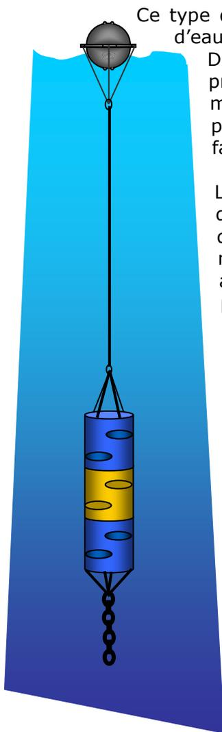
Ce type de mouillage est utilisé pour déterminer la dérive d'une masse d'eau au niveau de la surface et jusqu'à 1000 mètres de profondeur. Dans notre cas, nous conseillons fortement de se limiter à la profondeur maximale de 30 m pour des raisons de fiabilité avec les matériaux abordables pour un projet de jeunes. Une étude plus poussée (modélisation et simulation) permettra dans l'avenir de faire évoluer ce choix.
