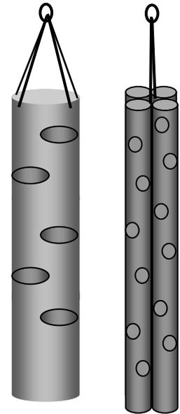
Exemples d'ancres flottantes : le tunnel de tissu et au fond le tube de PVC.
