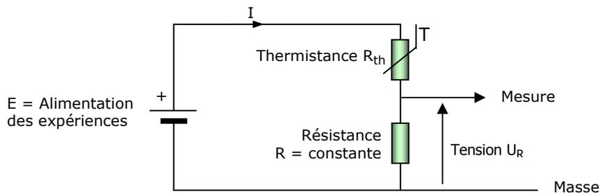
$$\text{Avec } U_R = RI \text{ et } I = \frac{E}{R_{th} + R}, \text{ on trouve } U_R = \frac{RE}{R_{th} + R}$$
