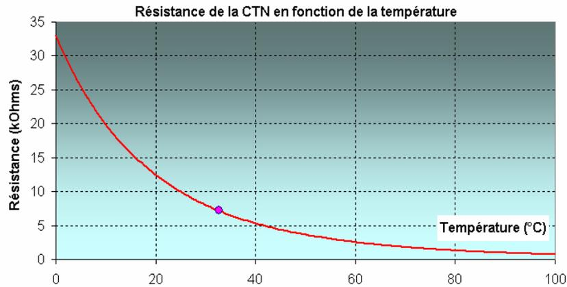
Le paramètre physique fait varier la résistance du capteur. Monter la thermistance en **pont diviseur** avec une résistance fixe permet d'obtenir une tension  $U_R$  qui varie en fonction de la température.
